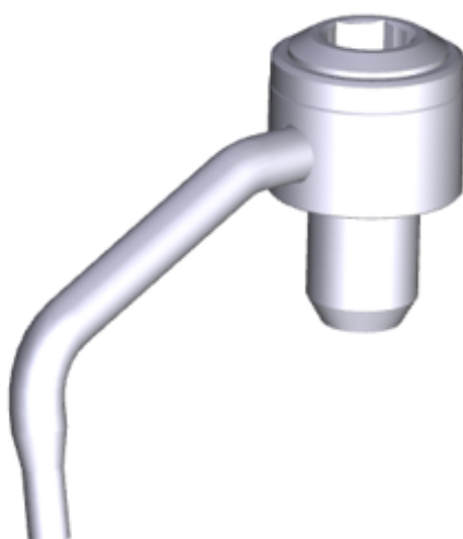
Bico injetor de óleo após a montagem e dobra do tubo
